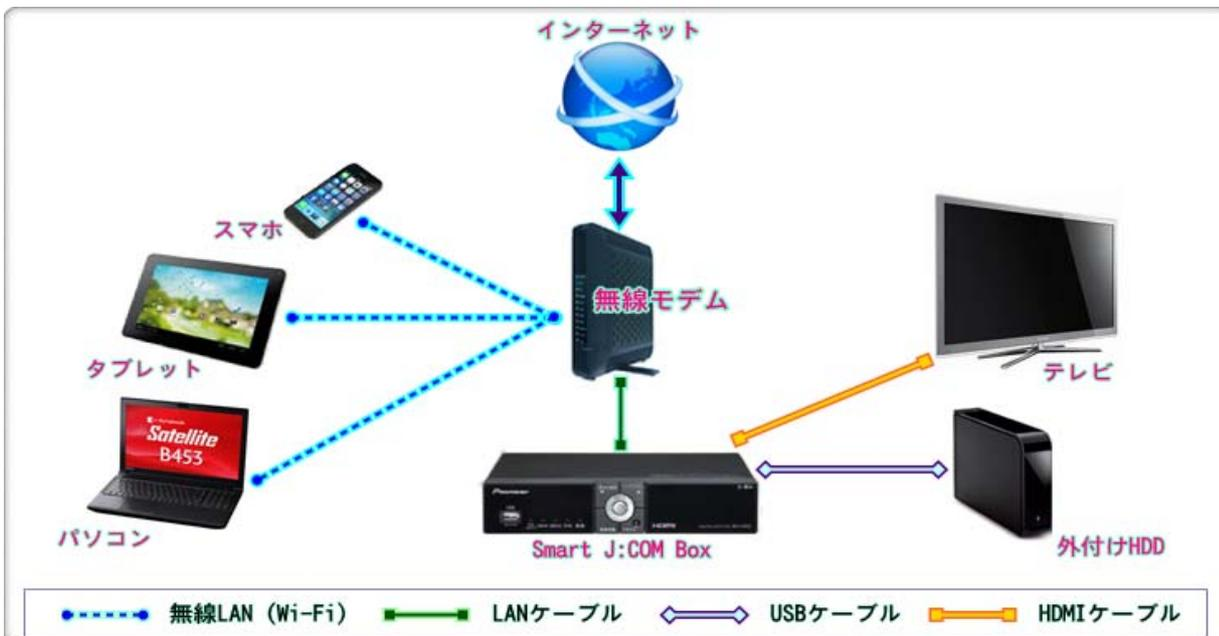
【02】無線モデムに、Smart J:COM Boxを有線接続 / LAN録画対応機器を利用の場合
